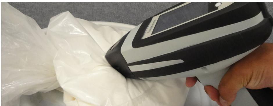
El analizador puede medir directamente a través de la bolsa de plástico o de contenedores de vidrio, permitiendo el análisis sin abrir el empaque.
