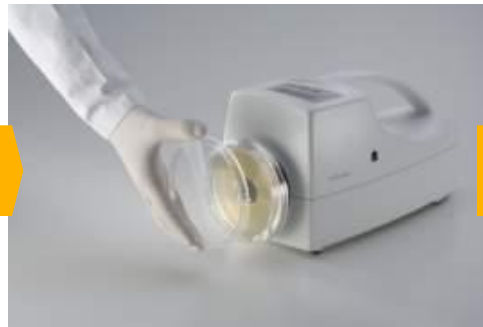
2. Instalar la cubierta de tope
